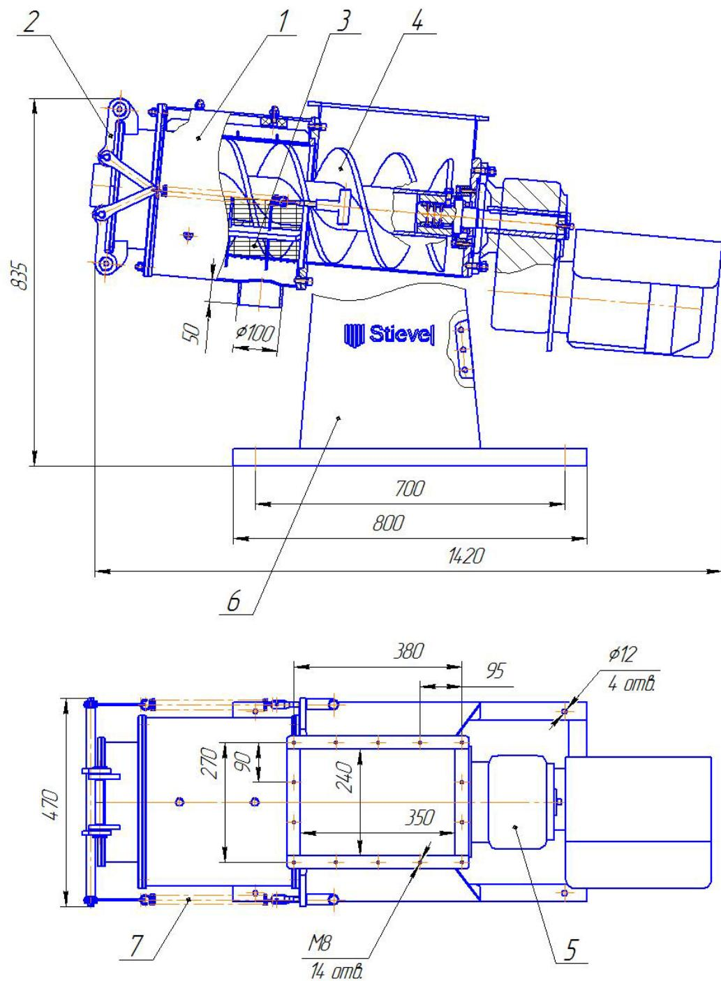
Рис.1 Сепаратор шнековый
