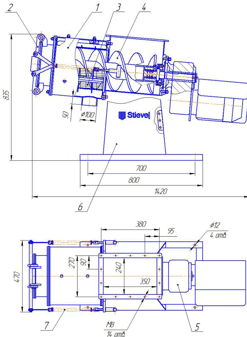
Рис.1 Сепаратор шнековый
